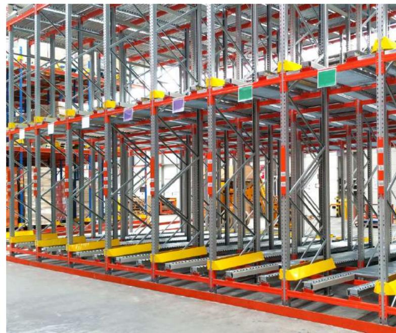
**Variante :** palettier dynamique à gravité inversée (Push-back, pallet rack). Le chargement et le déchargement est réalisé du même côté. Lorsqu'une palette est ajoutée, elle pousse vers l'arrière les palettes précédemment stockées sur la même rangée. Pour une gestion LIFO (Last In First Out), le palettier est généralement placé contre le mur du bâtiment.
