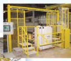
Barrière de type LS entièrement automatisée avec des garde-corps coulissants à l'avant et un système de barrière levante à l'arrière.
