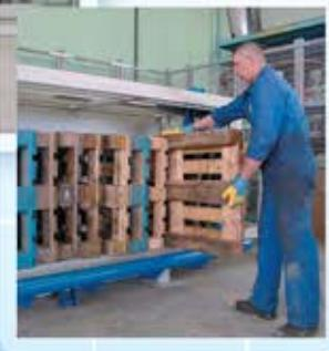
Le trieur-cadreur de palettes facilite la tâche des opérateurs pour la prise des palettes et recadre la pile automatiquement.
