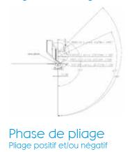
Système de réglage de la courbure et de l'épaisseur de la tôle par le biais d'indicateurs mécaniques de précision.
