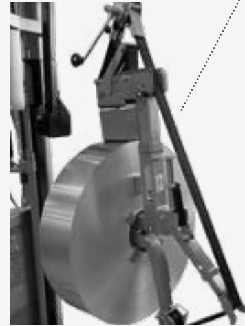
Feuillard en position axe horizontal prêt à être positionné sur un dérouleur / Roll in a horizontal position ready to be positioned on a decoiler
