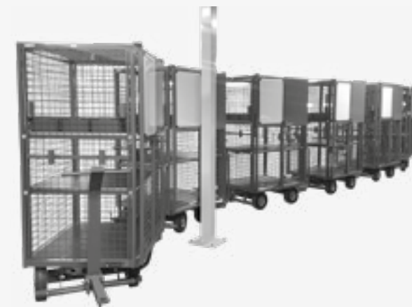
Mise en train pour faire le trajet du magasin à la rame / Coupled together to make the journey from the warehouse to the wagon
