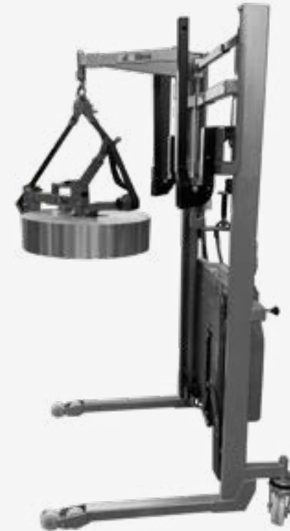
Feuillard en position axe horizontal prêt à être positionné sur un dérouleur / Roll in a horizontal position ready to be positioned on a decoiler
