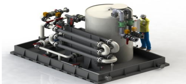
Skid automatique de dilution et de refroidissement d'acide sulfurique, avec récupération de la chaleur de réaction.
