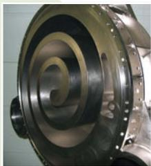
• Corps de pompe à vide de haute précision : nickelage en 50 $\mu$  suivi d'un traitement thermique de «diffusion» (600°C), le «nec-plus-ultra» de la protection corrosion.
