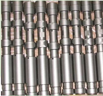
• Le chrome dur 'mince' (de 10 à 50µ environ) sera utilisé pour préserver vos pièces mécaniques soumises au frottement. Il est utilisé sur des vérins, des portées de joint, des pistons, des arbres, des rouleaux frottant l'un sur l'autre ou sur vos produits.
