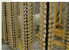
• Pièces en laiton, nickelées en faible épaisseur pour une protection corrosion et mécanique «légère».
