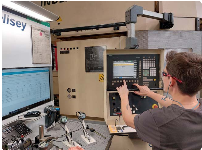
Dans le cas du site Lisi, à Melisey, l'APC d'Ellistat est interfacé avec le MES de l'équipementier automobile et les corrections sont directement transférées aux multibroches.
