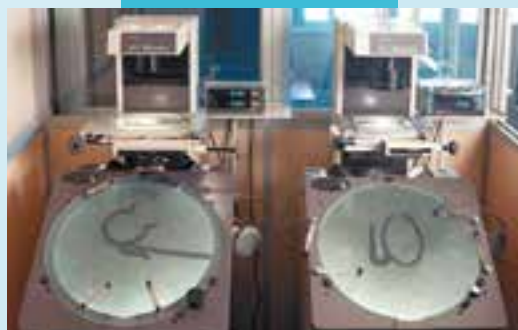
Contrôle des produits fabriqués par projecteur de profil échelle 5 et 10.
