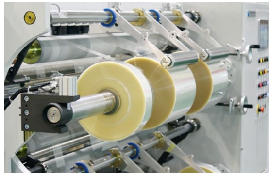
Contrôle de tension
