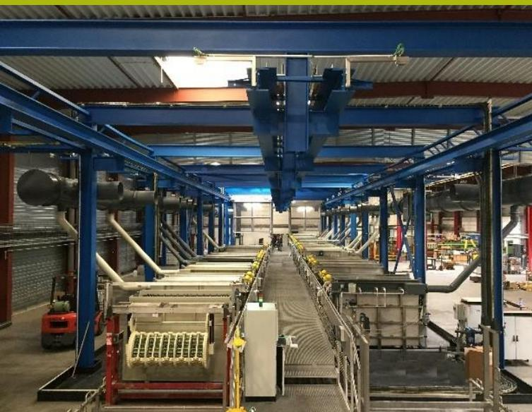
Flexible, moderne et performant, ce nouvel outil est capable de traiter simultanément en nickelage ou en chromage-dur différents matériaux.
