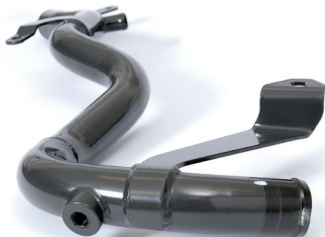
Tube acier Ø 50 x 1,5 mm avec pattes de fixation pliées, bouchon de purge, cataphorèse et peinture.
