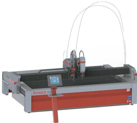
La table de découpe comprend un châssis de précision en acier intégrant des moteurs linéaires à entraînement direct sur chacun des deux axes principaux. Pour atteindre l'objectif de précision, le pont et le chariot sont actionnés par deux moteurs linéaires installés de chaque côté. Il en résulte une plage de vitesse allant de 1 à 30.000 mm/min.
