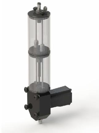
En général, le coût de l'abrasif compte pour environ un tiers des coûts opérationnels d'une machine à jet d'eau abrasive. Le doseur d'abrasif est conçu pour fournir une quantité d'abrasif parfaitement ajustée au processus de découpe jet d'eau. Il se compose de deux mini-réservoirs superposés et d'un ensemble de dosage motorisé et contrôlé numériquement.
