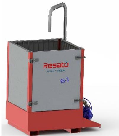
Le système d'élimination des boues d'abrasifs de type RS3, comprend un filtre, une tubulure spéciale d'aspiration et une seconde de refoulement . Ces tubulures sont elles-mêmes dotées d'un certain nombre de buses d'entrée et de buses de refoulement et sont disposés dans le fond du bac de l'ACM.
