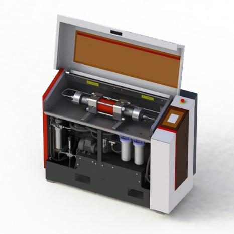
La pompe Resato PJ4-4000 fonctionne sur le principe du surpresseur, actionné par une pompe hydraulique à commande électrique utilisant seulement 25 litres d'huile. La pression des intensifieurs est contrôlable en continu depuis l'IHM ou la pompe, sur une plage de travail de 300 à 3800 bar. La pompe, via son automate à écran tactile, suivra les instructions du programme et ne consommera que l'électricité et l'eau si nécessaire.
