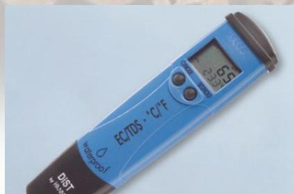
Appareil de mesure de l'eau : Permet d'analyser la conductivité de l'eau. (RB00441)
