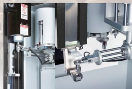
Guide intermédiaire et échangeur d'électrode CNC ATC (G), Changeur de guide CNC AGC (D)
