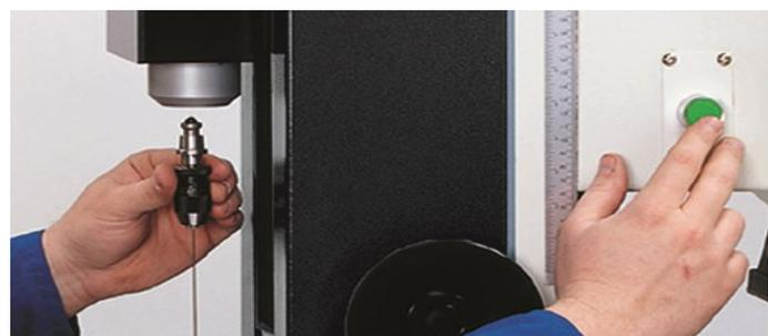
Équipement en option, gamme ZA : Système pneumatique de changement rapide d'électrodes
