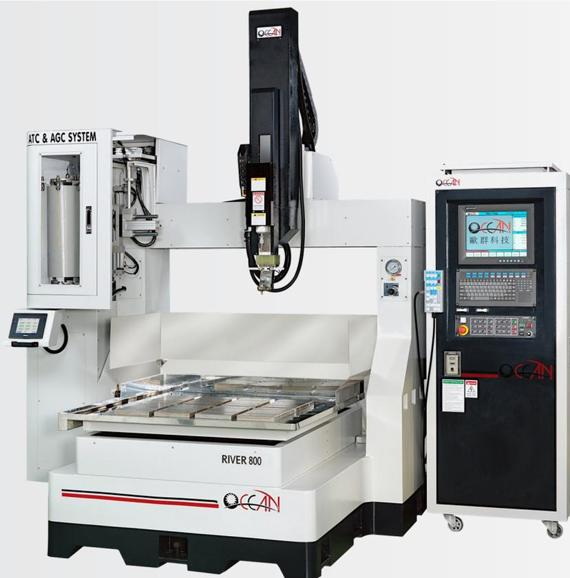
Courses extrêmement grandes, charge de table extrême de 1,8 tonnes, logiciel CNC Windows de pointe, conception Gantry pour une précision maximale. Ce sont les composants pour l'usinage d'avant-trous haute précision en format XXL. Machine de conception efficace et robuste, en service depuis de nombreuses années chez divers clients.
