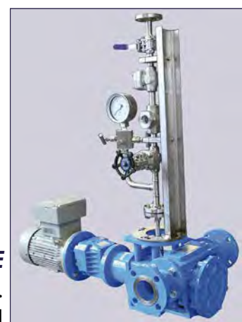
Pompe avec garniture mécanique API Plan 52 ATEX
