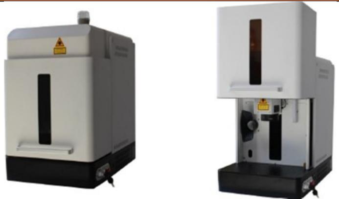
**Ne nécessite pas de port de lunettes spéciales de protection car le bâti est muni d'une sécurité (pas de gravure si la porte est ouverte).**
