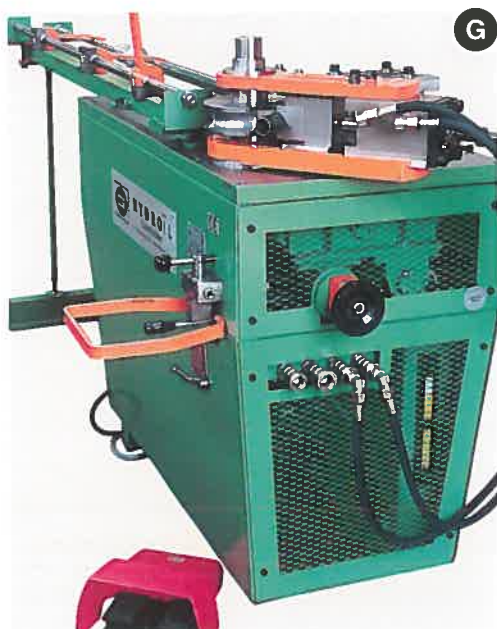
Cintrage par enroulement avec mandrin intérieur
