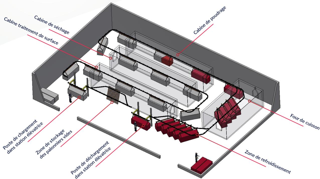
**Météor est un système de convoyeur aérien à chaîne mécanique monorail ou birail.** Il est principalement destiné au transport de **charges lourdes** allant **jusqu'à 9 tonnes**.
