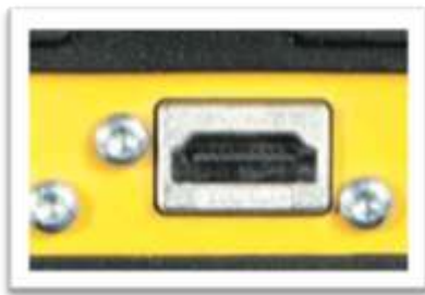
Ajout du connecteur HDMI au XT11
