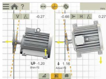
Alignez la machine en temps réel et documentez les résultats au format PDF (Application XT Alignment pour les courroies)
