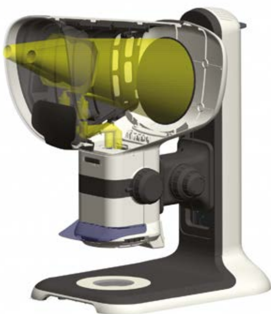
Deux chemins optiques (stéréo) projetés à partir du système de visualisation Dynascope®
