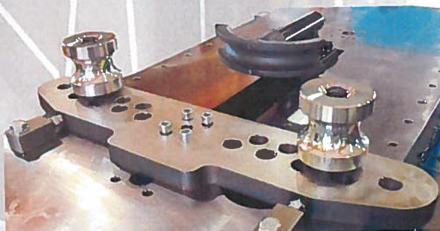
Outillage de cintrage de tubes par poussage
