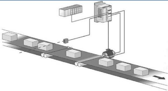
Le variateur est IP-66 et **peut donc être intégré hors armoire électrique** (voir photo ci-après) et dispose d'un interrupteur, d'un sectionneur et d'un potentiomètre en façade. Le variateur est alimenté en monophasé.
