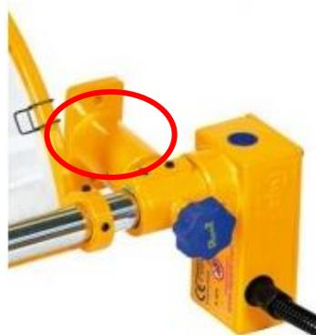
Le micro interrupteur sert à stopper la machine lorsque le capot est en position "ouvert".
